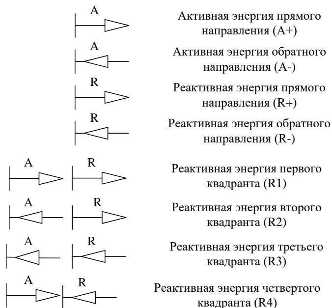
Рисунок 4 – Условные обозначения направления энергии, нанесенные на шкалу счетчика
